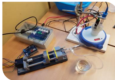
Essai du module mesure avec le pousse-seringue
